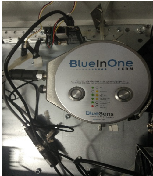
1.4 pav. BlueSens BlueInOne dujų analizatorius.
