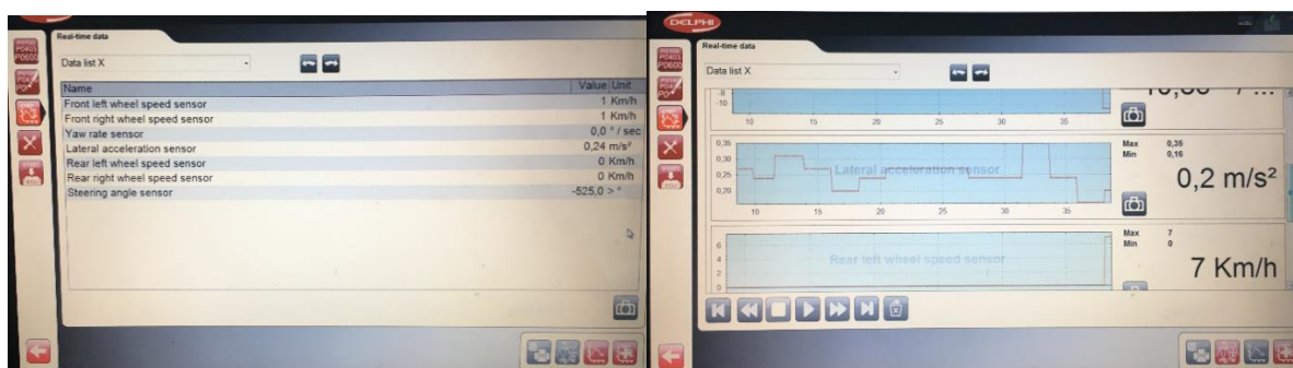
10 pav. Diagnostinės įrangos Autocom CDP+ fiksuojami ABS/ESP sistemų valdymo bloko duomenys: kairėje skaitinės duomenų reikšmės; dešinėje – grafinės
