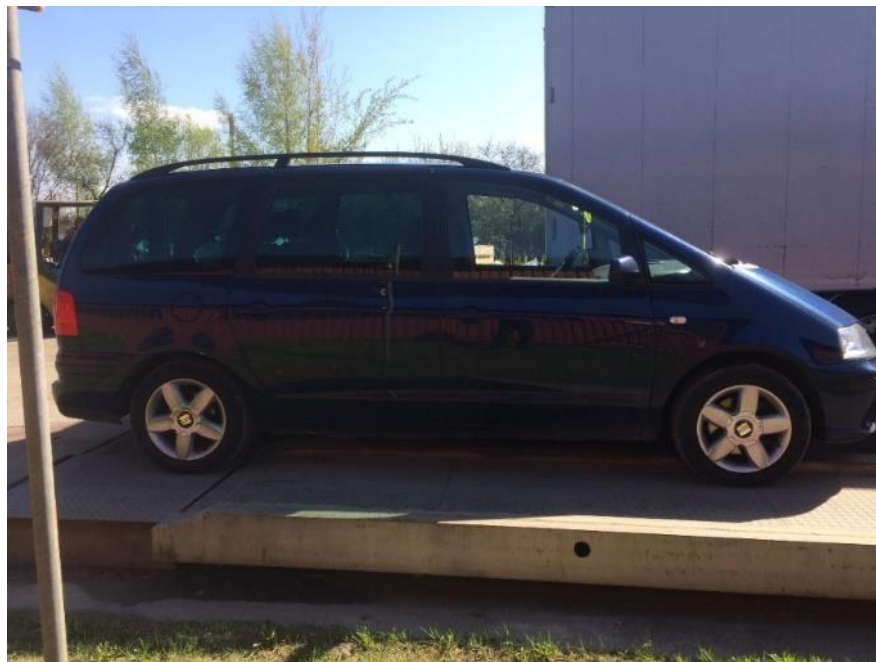
9 pav. Automobilis Seat Alhambra priekinės ašies svėrimo metu
