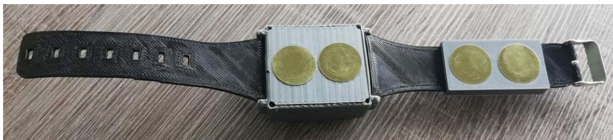
2.1 pav. Sukurtas MB „Fidens“ įmonėje ir tyrime naudotas ultragarsinės terapijos prietaisas
