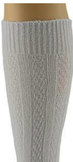
1.5 pav. Dviejų cilindrų kojinių automatu numezgto kraštelio pavyzdys [11]
