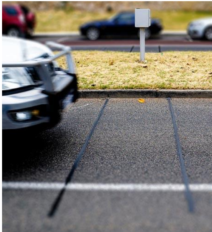
1.7 pav. Sumontuoti pjezoelektriniai jutikliai eismo srautų matavimui gatvėje [7]
