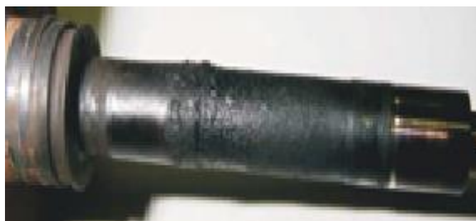
1.16 pav. Išsilenkęs turbokompresoriaus velenas [31]
