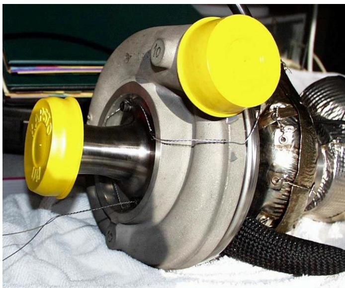
2.4 pav. Turbokompresoriaus plombavimo schema [17]
