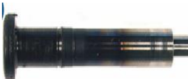
1.15 pav. Perkaitintas turbokompresoriaus velenas [31]
