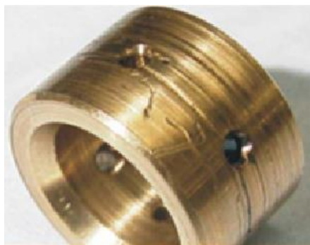
1.12 pav. Turbokompresoriaus veleno slydimo įvorė [31]
