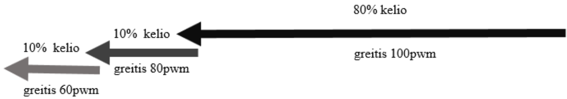
4.9 pav. Roboto greičio mažinimo procesas
