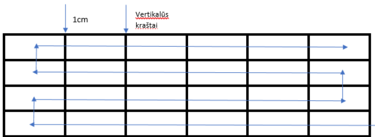
4.3 pav. Horizontalaus skenavimo schema
