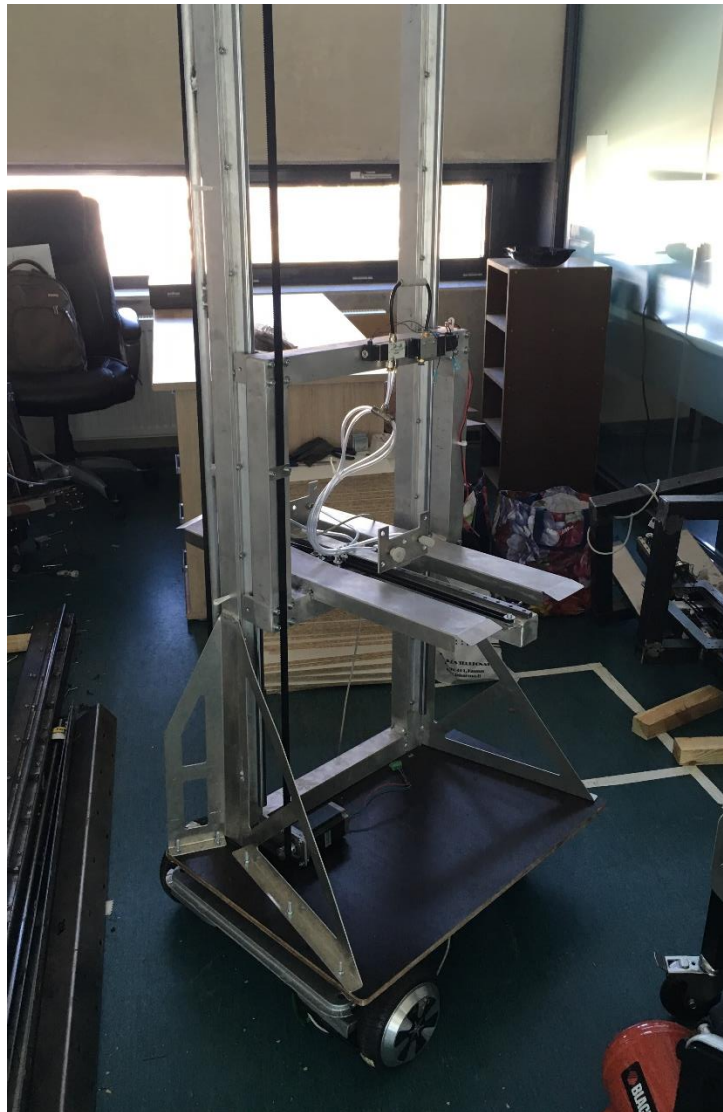
3.24 pav. Antrosios versijos roboto prototipas su uždėtu paėmimo įrenginiu
