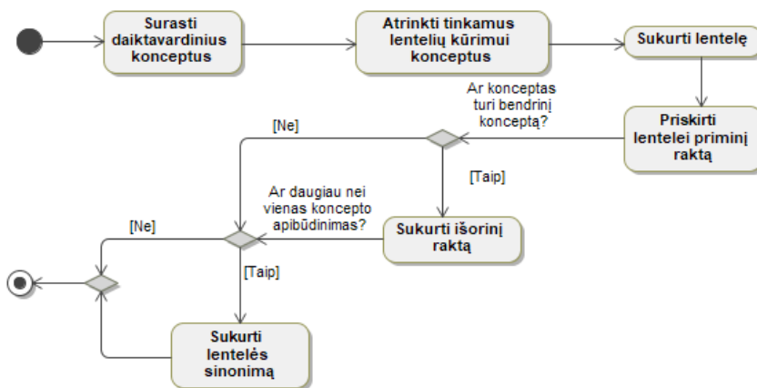
2.20 pav. Daiktavardinių konceptų transformavimo veiklos diagrama
