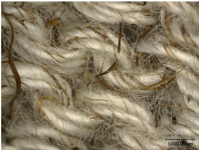
3.8 pav. Iš mišriapluoščių durpių verpalų numegzto mezginio paviršiaus vaizdas
