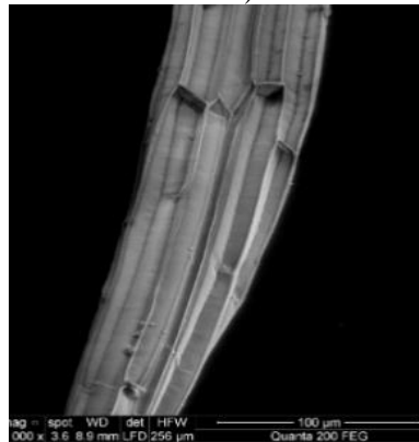
3.2 pav. Švylių pluošto SEM vaizdai: (a) skerspjūvis, (b) ir (c) pluošto paviršiaus vaizdas
