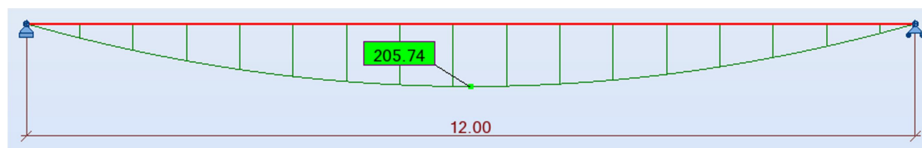
3.11 pav. M_y lenkimo momentu diagrama (kNm)
