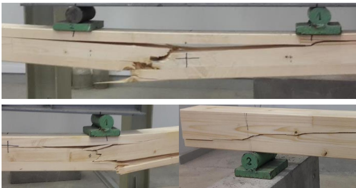
49 pav. Klijuotos medienos suirimo pobūdis
