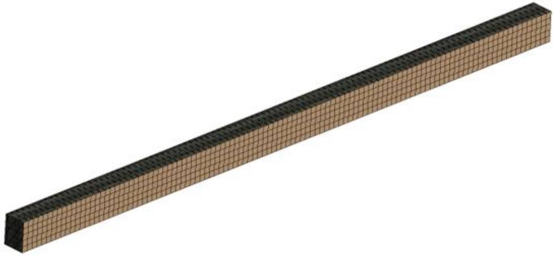
27 pav. LVL sijos skaitinis modelio skaidymas į baigtinius elementus (Mesh) ANSYS programoje
