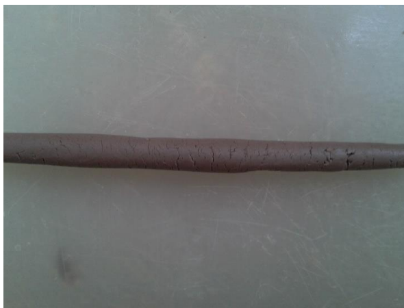
11 pav. Plastiškumo drėgnio grunto volelis
