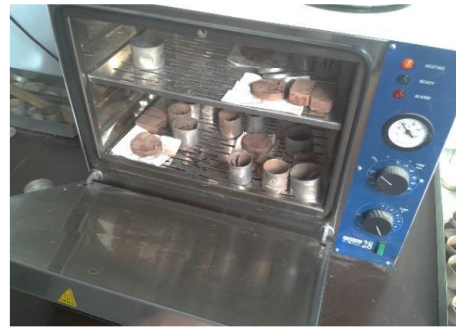
9 pav. Elektrinė džiovimo krosnelė
