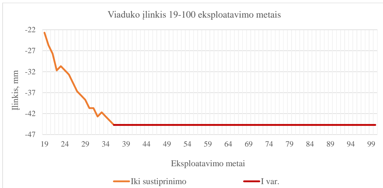
53 pav. Viaduko įlinkis 19-100 eksploataavimo metais, nevertinant laikinos apkrovos
