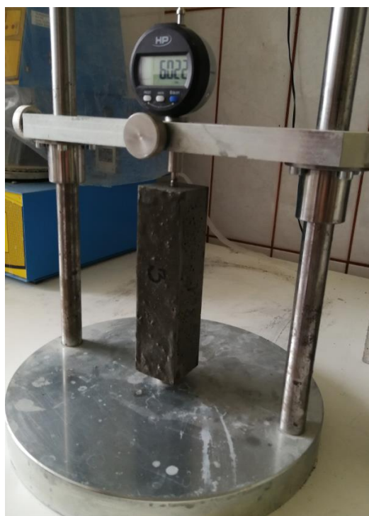
3.5.1. pav. Betono bandinių susitraukimo deformacijų matavimo įranga
