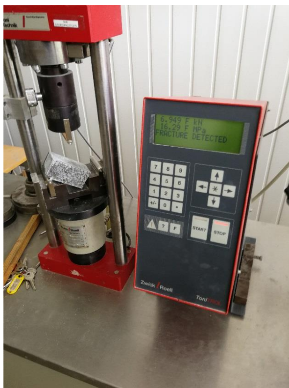
3.3.1. pav. Betono bandinių stiprumo nustatymas hidraulinių presu „Toni Technik 2020“
