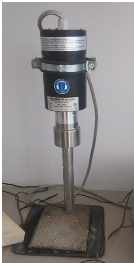
2.3.1. pav. Ultragarso dispergatorius „Bandelin electronic UW3400“
