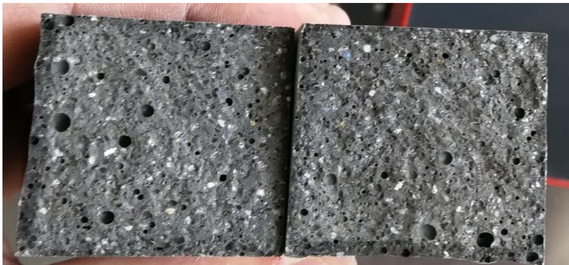
3.6.1. pav. Betonų bandinys po lenkimo stiprio nustatymo bandymo su poromis
