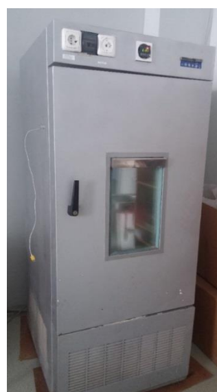
3.7.1. pav. Ypač stipraus betono bandiniai įmerkti į 3% druskos tirpalą, bei šaldymo kamera.
