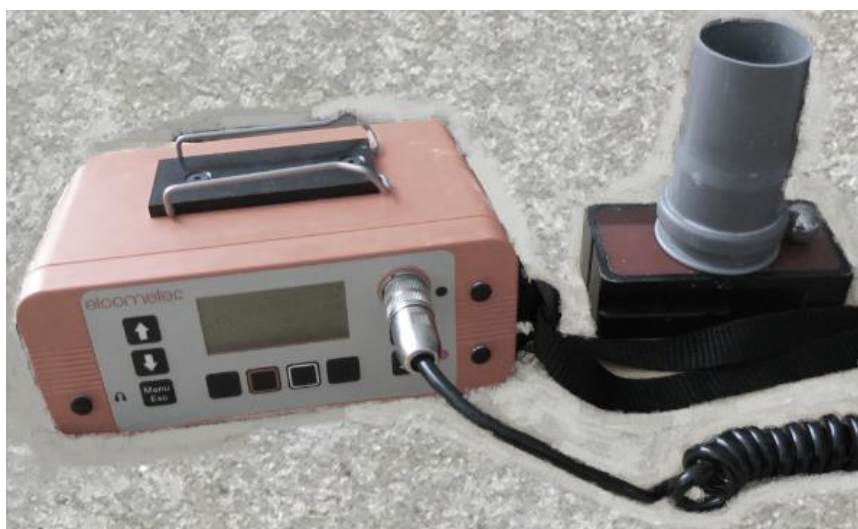
2.5.1. pav. Betono mišinio klampos nustatymo įranga
