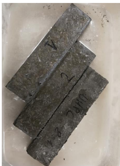
3.7.1. pav. Ypač stipraus betono bandiniai įmerkti į 3% druskos tirpalą, bei šaldymo kamera.
