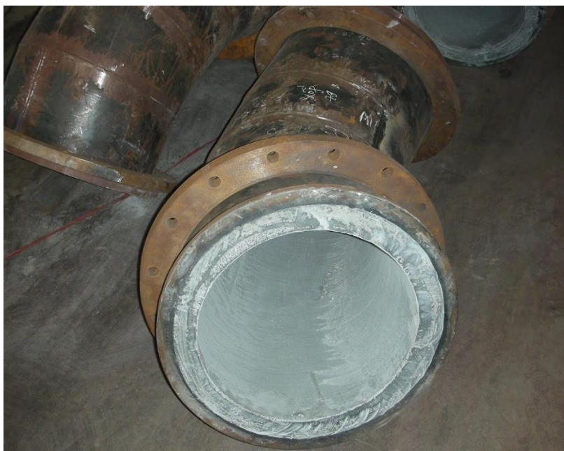
1.9.4. pav. Didelio gabarito vamzdžio mova, pagaminta naudojant ypač stiprųjį betoną.
