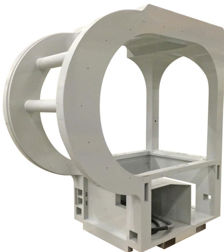
1.3.1. pav. Roboto konstrukcijos korpusas pagamintas iš ypač stipraus betono. (Sudholt-Wasemann group.2017)
