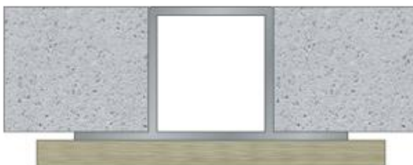
48 pav. „Thorbeam“ sijos ugniaatsparumo didinimas naudojant apsaugos nuo ugnies plokštes [16]
