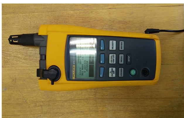
2.4 pav. CO 2 matavimo prietaisas „FLUKE 975 AirMeter“
