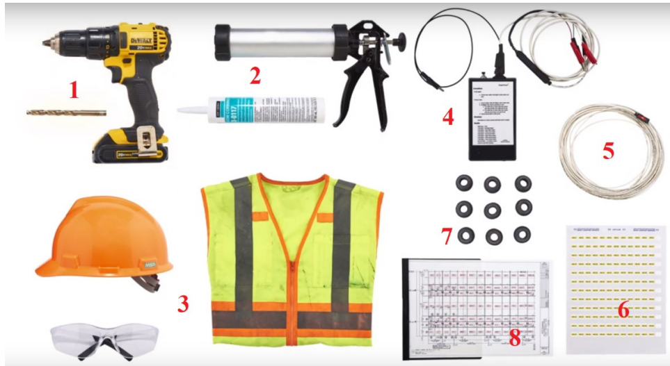
28 pav. Elektrochrominių stiklų įrengimui būtini įrankiai, priemonės.
