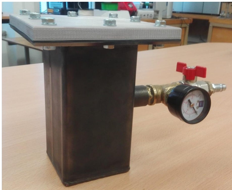
21 pav. Slėginis indas, su jau pritvirtintu dangteliu, spausdintu iš PLA plastiko.
