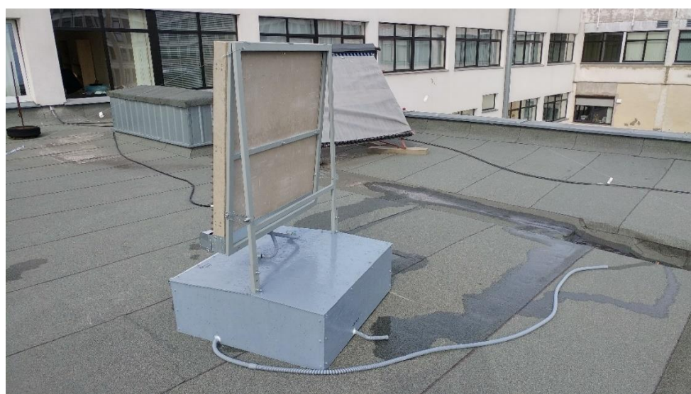
2.11 pav. Stendas, paruoštas ilgalaikiam bandymui realiomis sąlygomis
