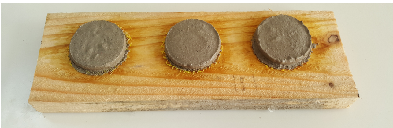
30 pav. Sukibimo su paviršiumi stiprio bandymui paruošti bandiniai.
