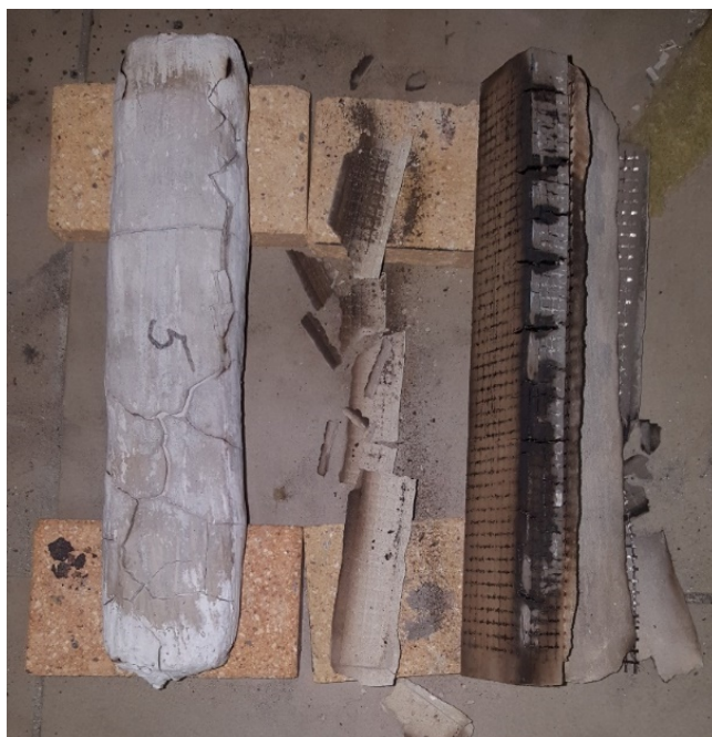
39 pav. Bandymo rezultatai po 10 min kaitinimo.
