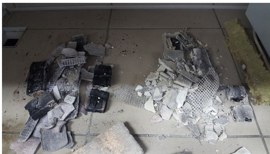
38 pav. Bandymo rezultatai po 30 min kaitinimo.
