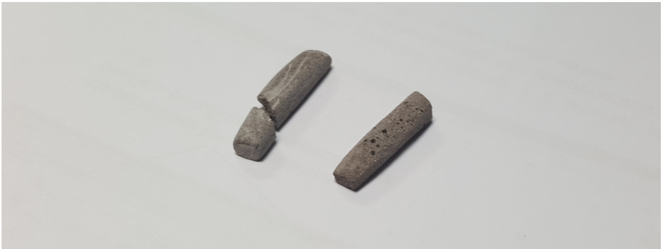
32 pav. Šarmu aktyvuoto šlako bandiniai kaitinti horizontaliame dilatometre.
