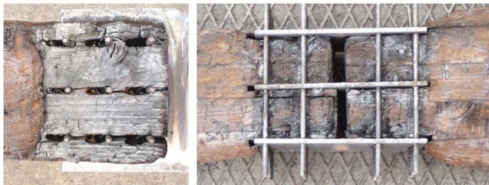
7 pav. Medinių elementų sujungtų metalinėmis detalėmis suirimas.
