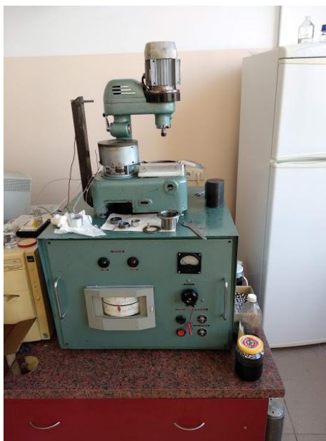
2.3 pav. Tyrimams atlikti naudojamas keturių rutulių alyvos tyrimo stendas
