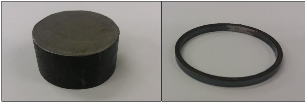
16 pav. Įvorė ir žiedas naudojami anglies pluošto vamzdelių bandinių galų sustiprinimui
