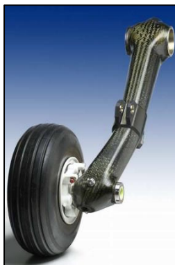
7 pav. Sraigtasparnio NH-90 važiuoklės atrama pagaminta iš anglies pluošto [8]
