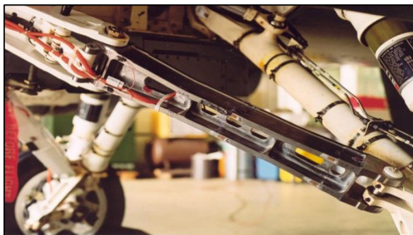
5 pav. Naikintuvo F-16 važiuoklės atrama paruošta realaus skrydžio bandymams [7]
