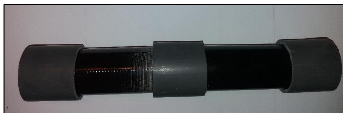
25 pav. Lenkimo bandymams atpjautas bandinys su plastmasiniais žiedais
