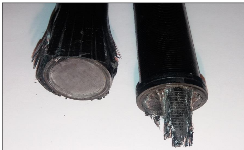
24 pav. Bandinių galai po bandymų su 500 kN mašina (kairėje – pirmasis bandinys, dešinėje – antrasis)
