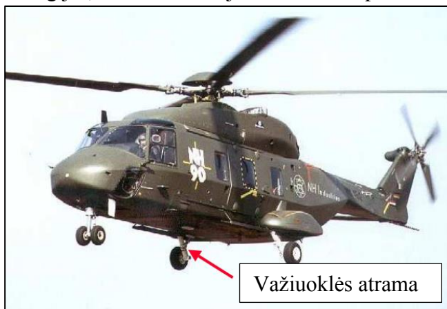
6 pav. Sraigtasparnis NH-90, kurio važiuoklės atrama modifikuota [8]
