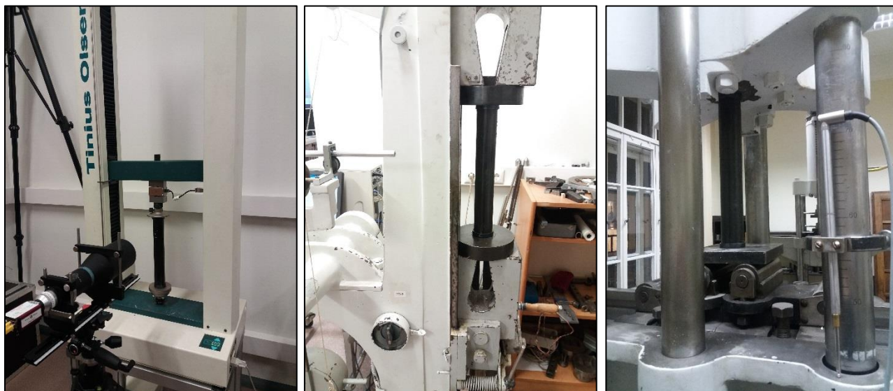
19 pav. Bandiniai paruošti bandymams su kiekviena bandymų mašina (kairėje – 25 kN bandymų mašina, centre – 50 kN bandymų mašina, dešinėje – 500 kN bandymų mašina)
