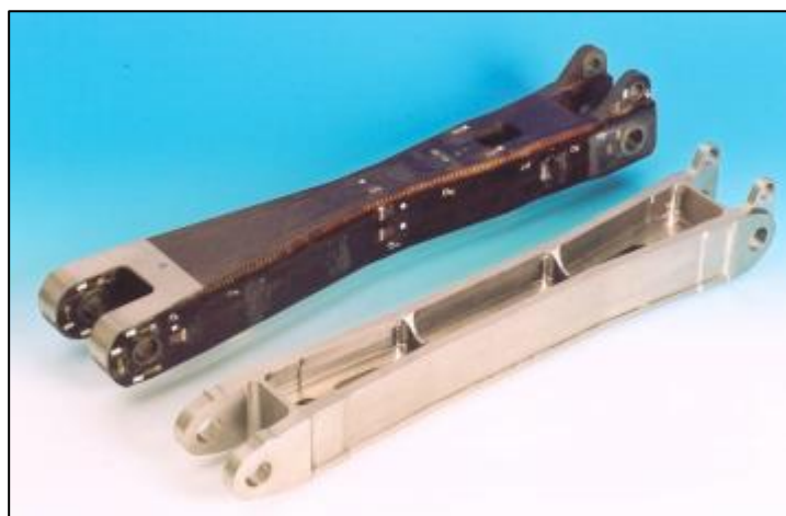
4 pav. Naikintuvo F-16 pagrindinės važiuoklės atramos [7] pagamintos iš polimerų matricos kompozito (kairėje) ir titano matricos kompozito (dešinėje)
