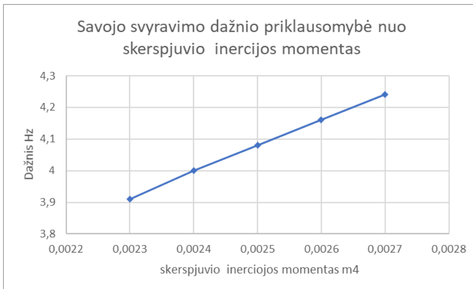
6.2.3 diagrama. Savojo svyravimo dažnio priklausomybė nuo skerspjuvio inercijos momento
