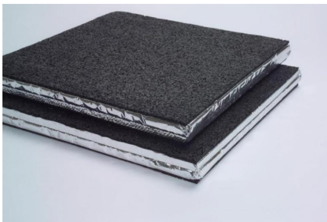
20 pav. Vakuuminė šilumos izoliacija ( https://www.ekspertai.lt )
