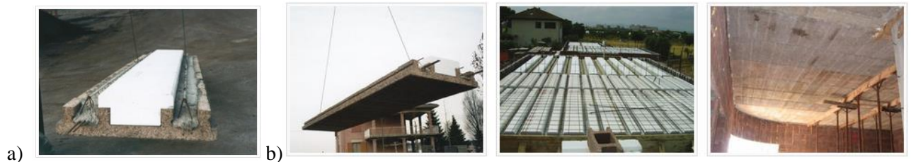
2.16 pav. a – „Durisol“ „SOLAFON“ perdangos plokštė [25]; b – perdanga iš „Durisol“ „SOLAFON“ plokščių [25]
