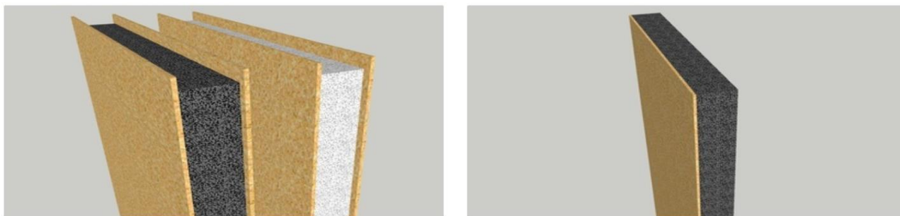
9.1 pav. „SIP“ skydai ir papildoma sienų apšiltinimo plokštė
