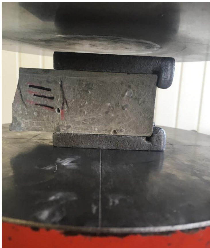
19 pav. Bandinys paruoštas gniuždomojo stiprio bandymui
