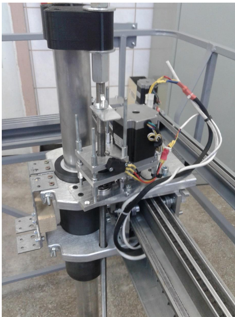
8 pav. Žingsninių varikliu sujungimas su srieginėmis ašimis
