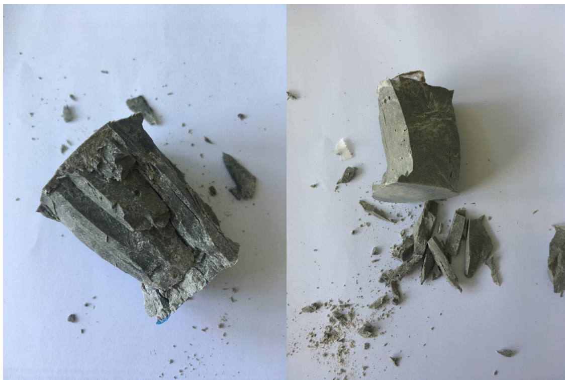
29 pav. C75+F15+SM10 ir C65+F15+SM20 po gniuždymo bandymo
