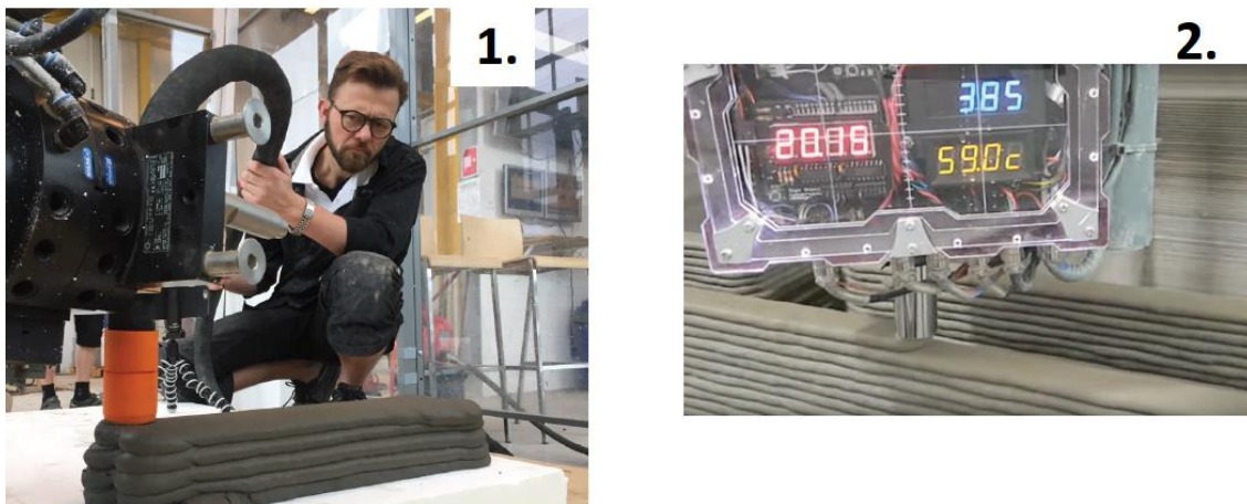
5 pav. 3D betono spausdintuvo valdymo antgaliai: 1. pasyvus valdymo antgalis, 2. aktyvus valdymo antgalis.
