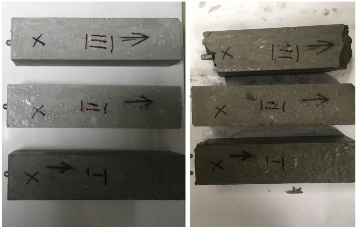
35 pav. Cementinio rišiklio bandiniai prieš ir po atsparumo šalčiui bandymo
