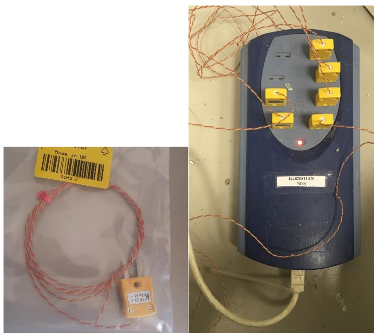
17 pav. pav. Termopora ; duomenų kaupiklis
