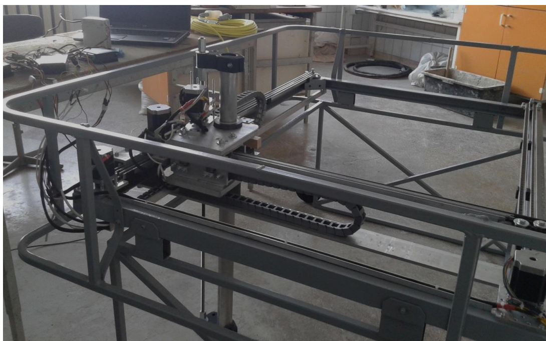
6 pav. Ašių išsidėstymas spausdintuvo prototipe
