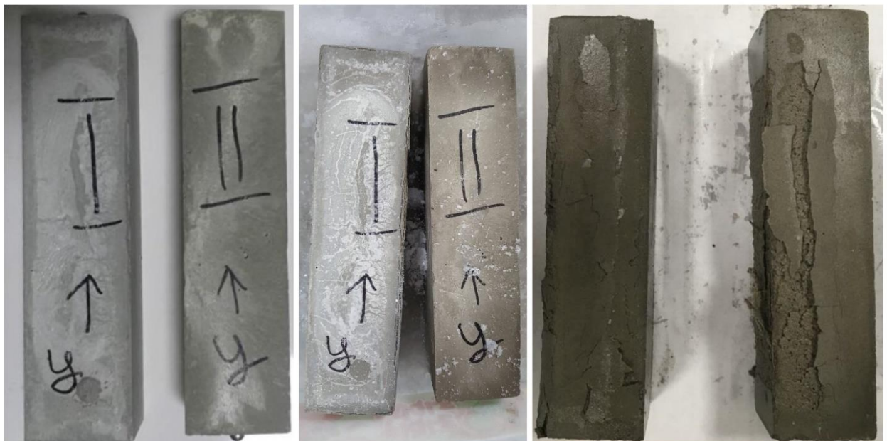
36 pav. Betono bandiniai prieš ir po atsparumo šalčiui bandymo
