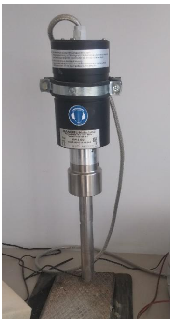
20 pav. Ultragarsinis dispergatorius „Bandelin electronic“
