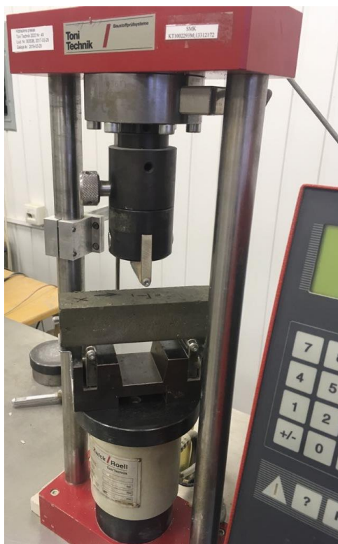
18 pav. Bandinys paruoštas lenkimo bandymui
