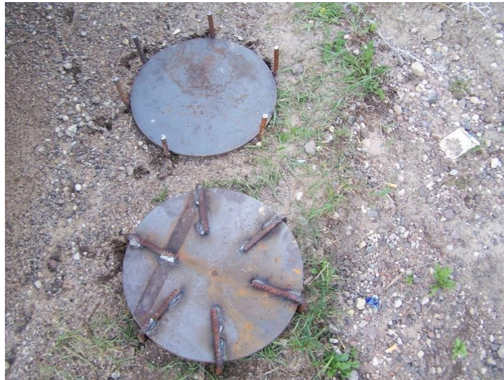
3.4.2.2 pav. Liekamoji spraustinio vamzdžio uždaru galu galva (UAB „VIACON BALTIC“ nuotrauka).
