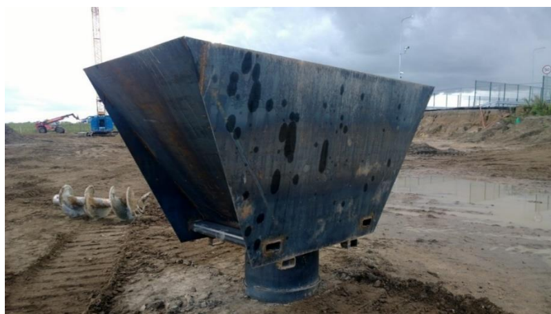
3.4.3.2 pav. Įrenginys skirtas užpildyti geotekstilės maišą (UAB „VIACON BALTIC“ nuotrauka)
