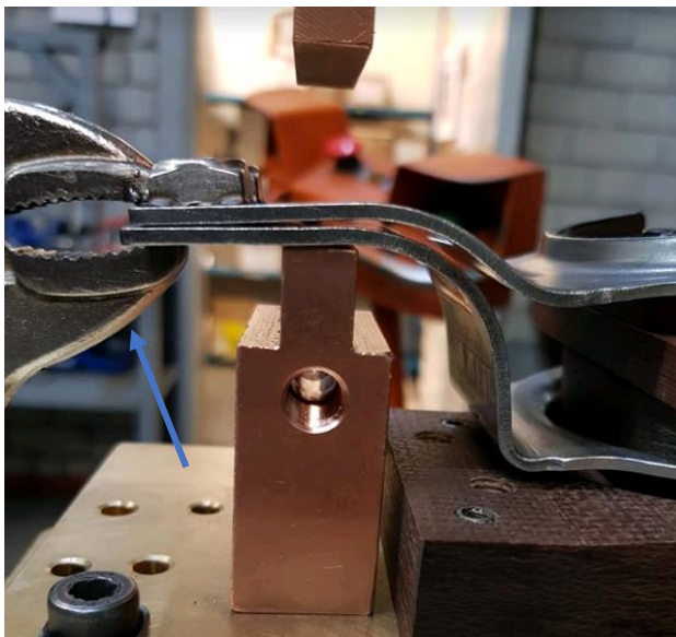
2.14 pav. Papildomas suvirinamų detalių suspaudimo vaizdas
