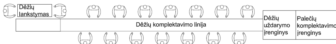
1.1 pav. Pakavimo linijos principinė schema
