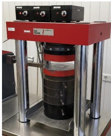
2.2.1 pav. „Toni Technik“ hidraulinis presas, stiprio gniuždant bandymams
