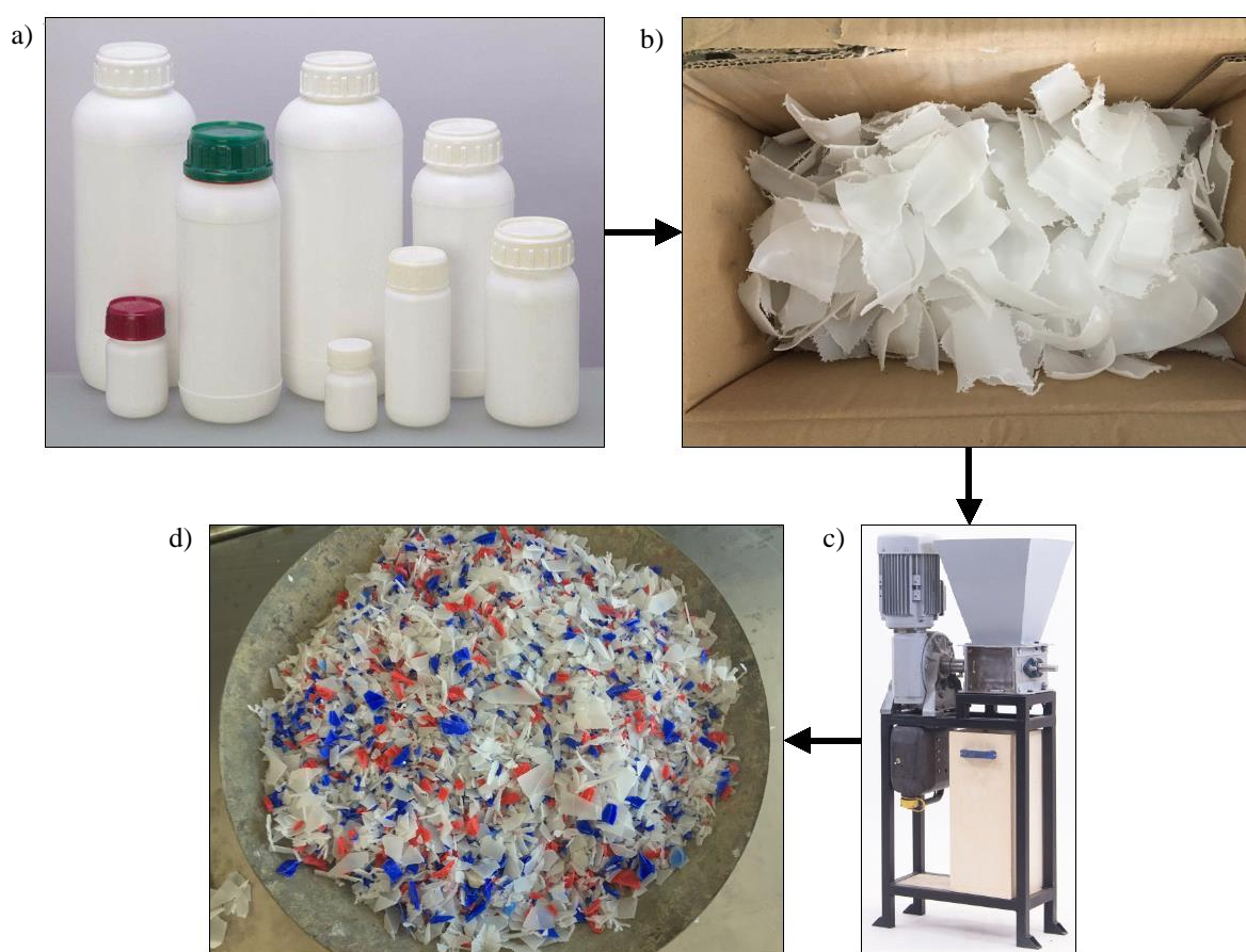
3.1.1 pav. Perdirbamo plastiko žaliavos paruošimo technologija (sudaryta autoriaus)
