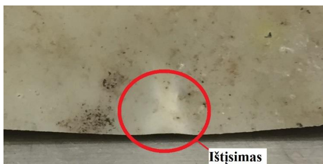
3.7.1 pav. HDPE100 prizmė, po stiprio lenkiant bandymo
