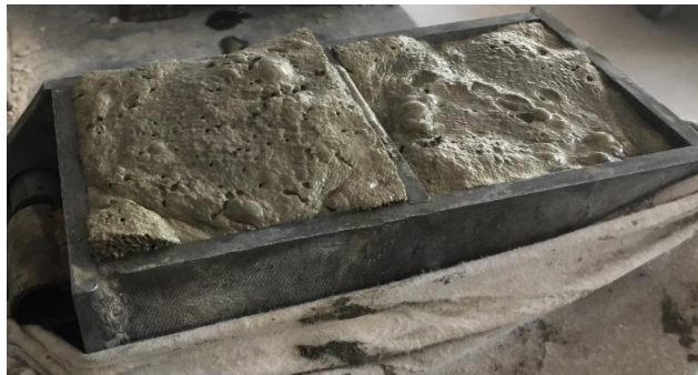
2.2.3 pav. Besiplečiantis ypač lengvo betono mišinys formoje
