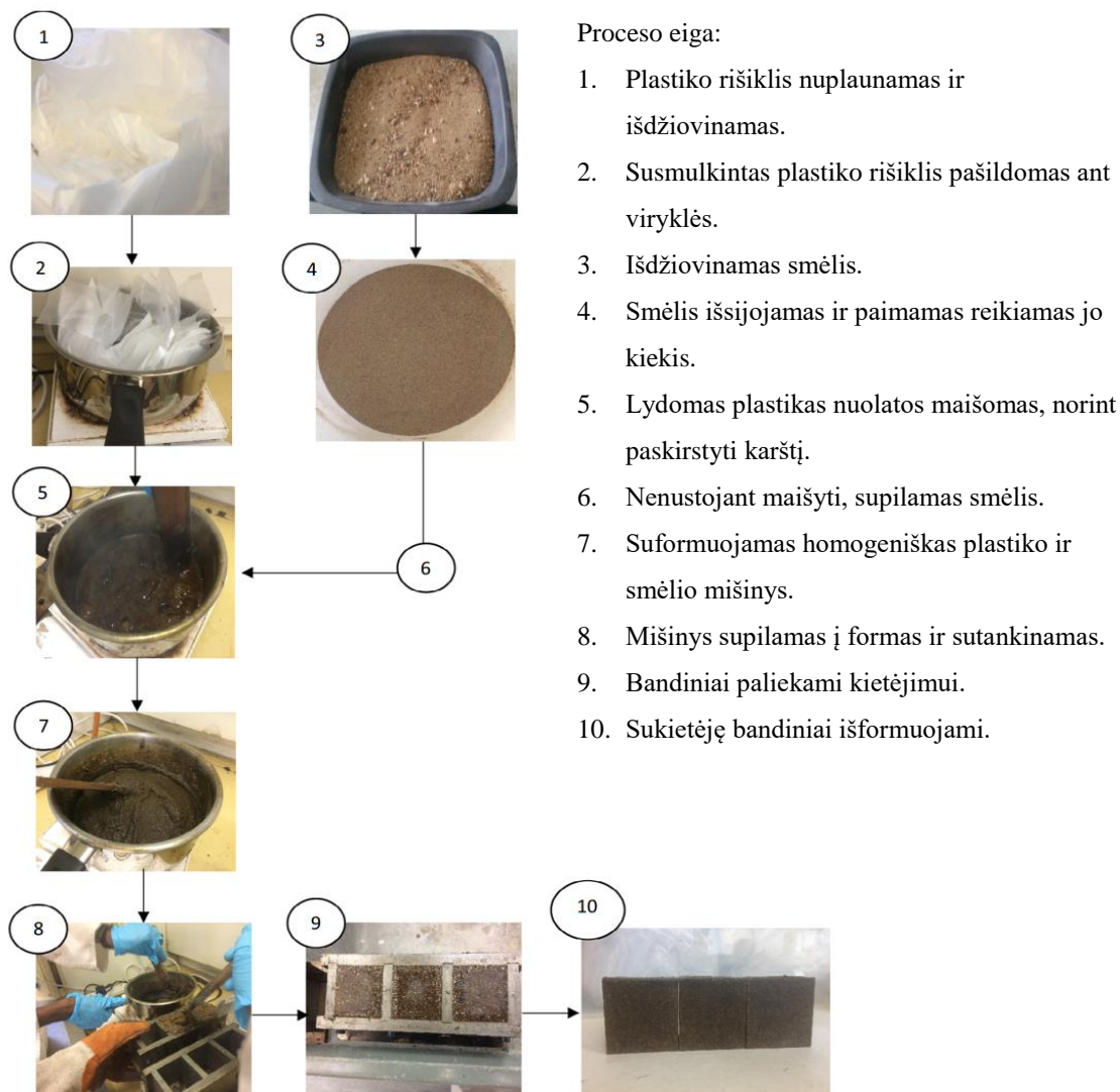
1.3.4 pav. LDPE-smėlio mišinio bandinių paruošimo technologija (Kumi-Larbi ir kt., 2018)
