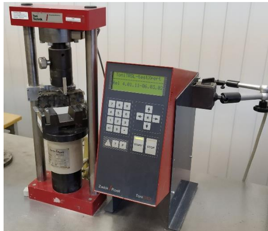
2.2.2 pav. „Toni Technik“ hidraulinis presas, stiprio lenkiant bandymams
