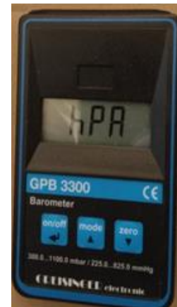
3.18 pav. Barometras Greisinger GPB 3300
