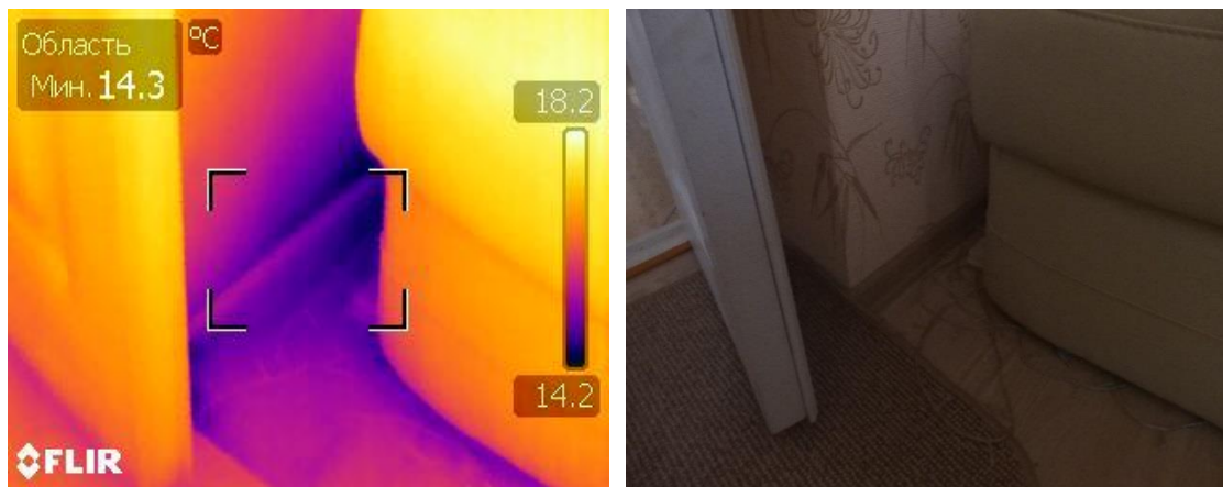
3.4 pav. Nuotėkio zona grindjuostės srityje
