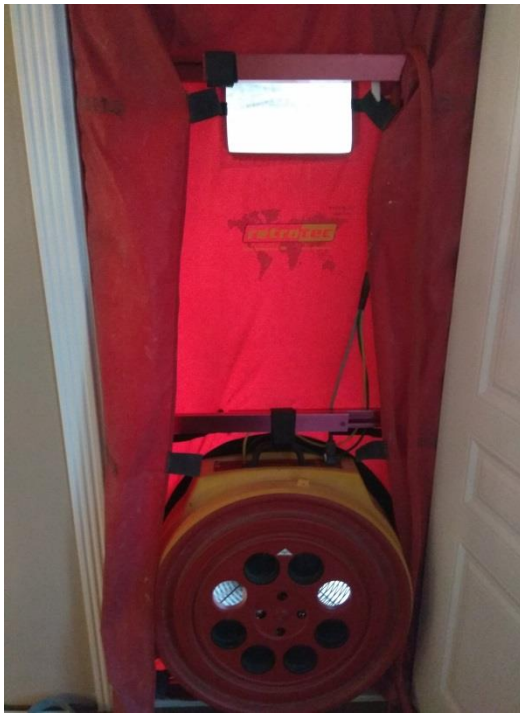
3.15 pav. Aerodurys Model 1000 Blower Door
