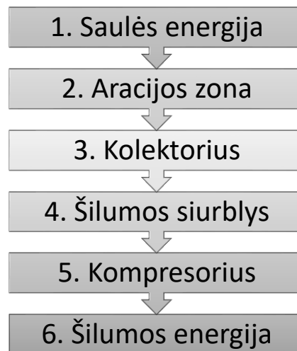
25 pav. Geoterminės, šilumos energijos, konversijos algoritmas
