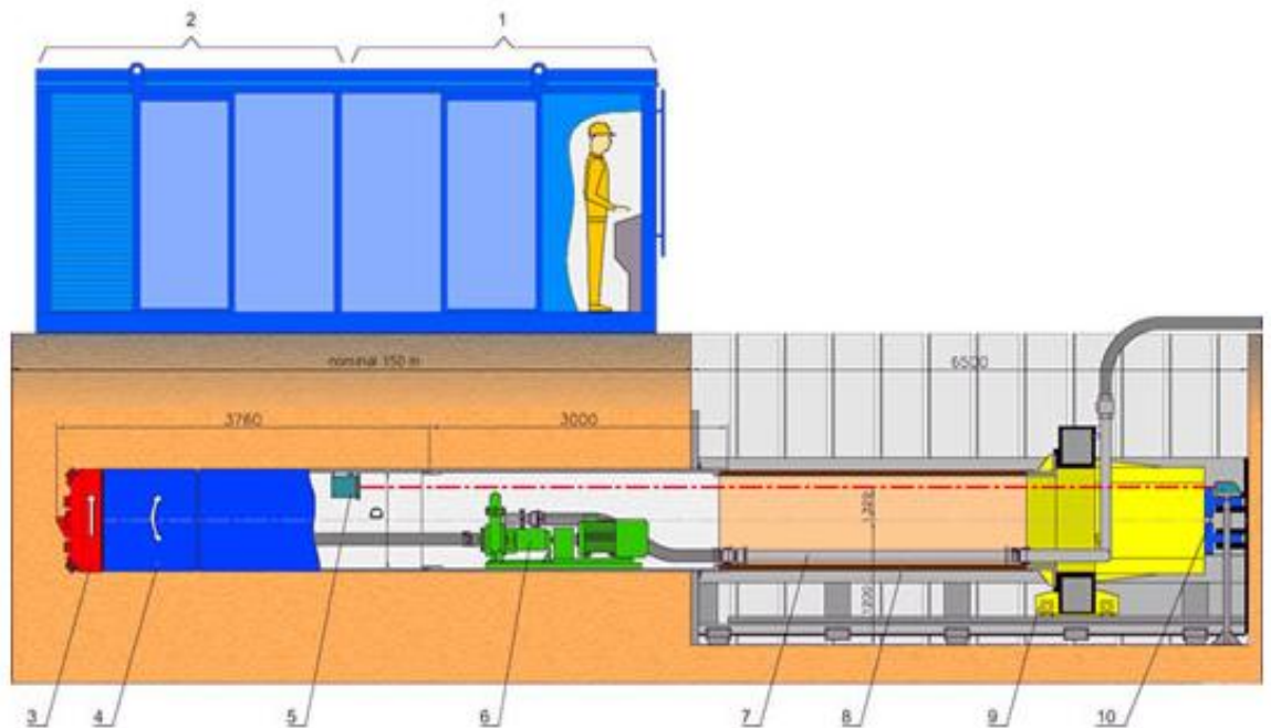
18 pav. Mikrotunelių įrengimo technologija [15]
