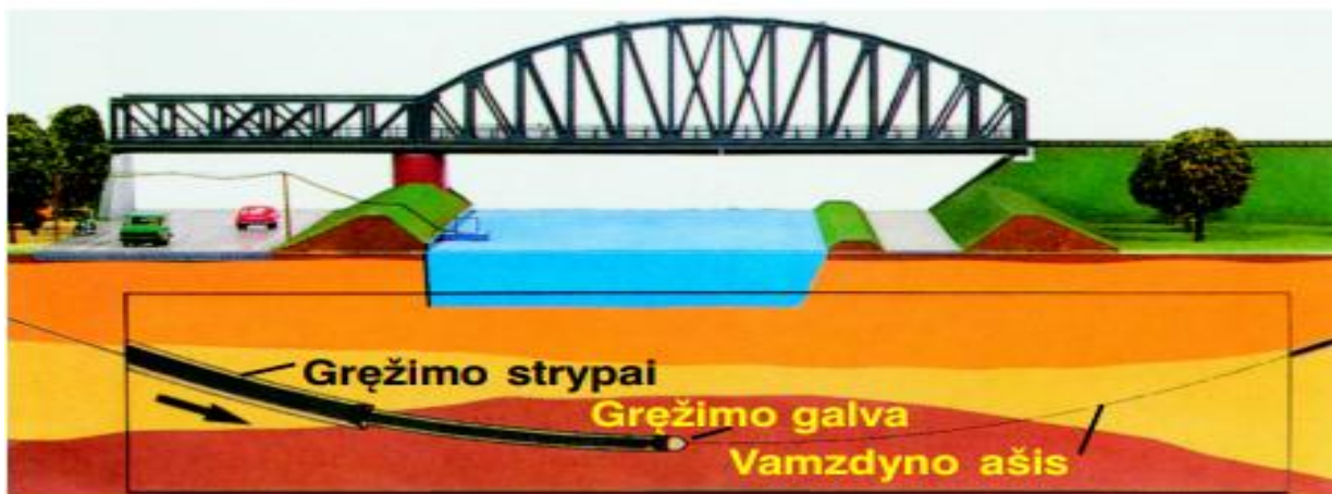
13 pav. Pilotinio gręžimo schema [16]
