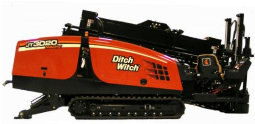
32 pav. Horizontalaus valdomo gręžimo įrenginys [35]
