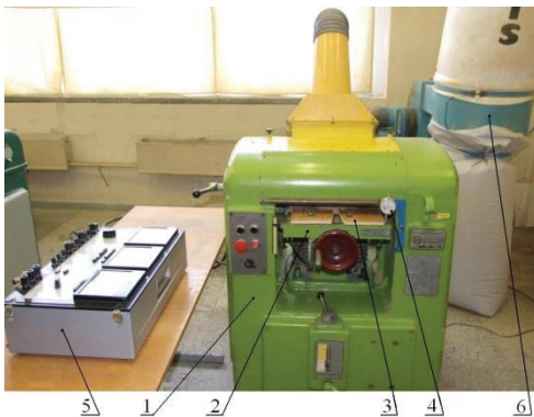
2.4.1 pav. Medienos frezavimo standas: 1 – reismusinės obliavimo staklės (SR3-6); 2 – darbo stalas; 3 – bandinių kreiptuvas; 4 – laikroдинis indikatorius; 5 – elektros srovės matavimo prietaisas (K506); 6 – aspiracinis įrenginys (Kadis SK-1)
