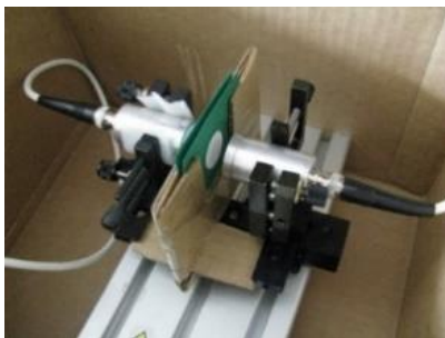
5.7 pav. Spektroskopijos matavimo sąranka
