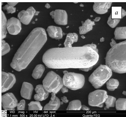
3 pav. Dūmų gipso kristalų SEM nuotrauka, esant skirtingiems didinimams: a – 500 kartų; b – 1 000 kartų
