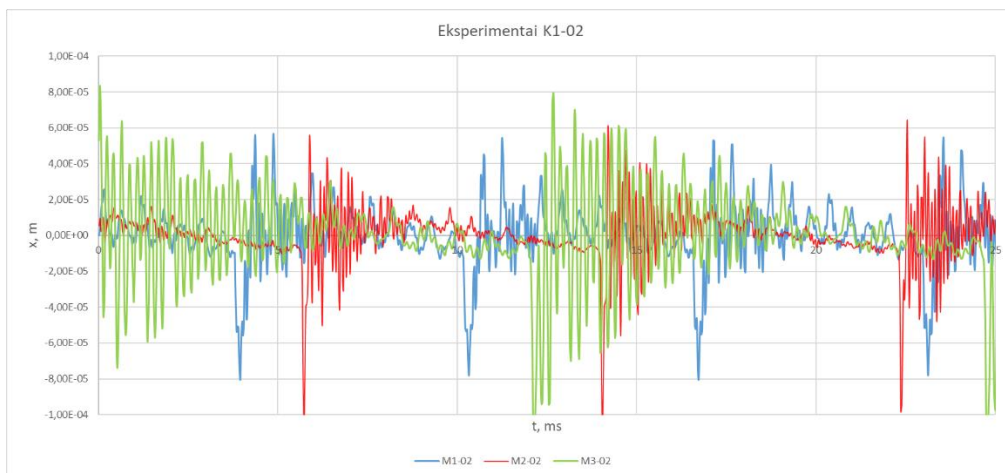
4.7 pav. Eksperimentų M1K1-02 ( mėlyna kreivė ), M1K2-02 ( raudona kreivė ), M1K3-02 ( žalia kreivė ) rezultatai: pneumatinio vibrosužadintuvo darbo kūno virpesių amplitudžių pokyčių diagramos laiko intervale nuo 0 iki 25 ms.
