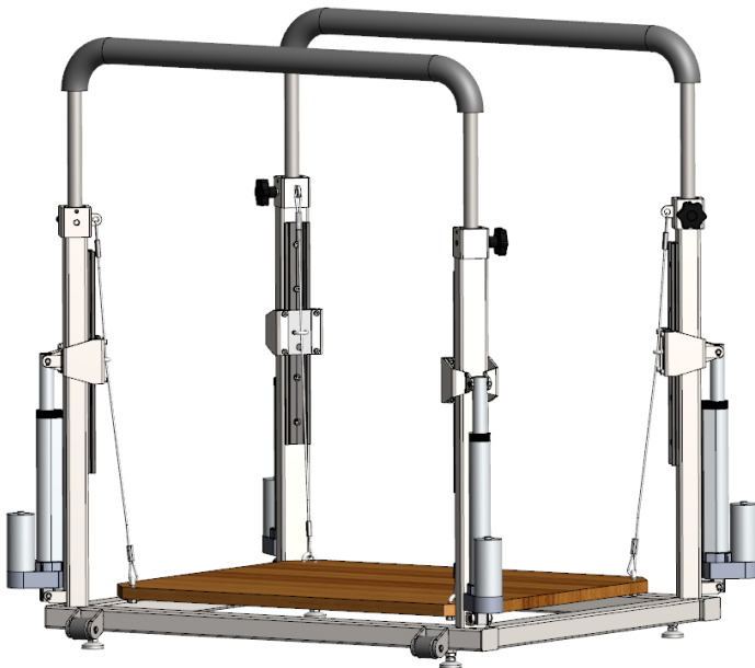
65 pav. Automatizuotos tyrimų platformos CAD vaizdas. Pakabinama plokštė pritvirtinta plieniniais lynais prie rėmo kolonų. Prie kiekvienos kolonos sumontuota po linijinę pavarą, kurios reguliuoja aktyvaus lino ilgį, taip keisdamos pakabos geometriją ir mechaninio nestabilumo lygį. Atviras aliumininis rėmas turi reguliuojamus apsauginius turėklus ir palieka laisvą prieigą prie jutiklių bei kabelių
