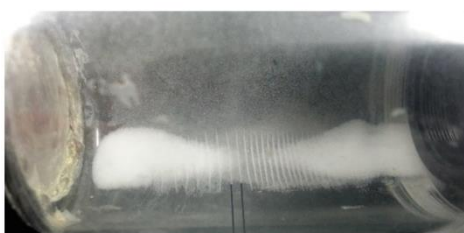
17 pav. Mikrodalelių sukėlimas cilindrinio indo sienelių savųjų formų mazginiuose pjūviuose esant įvairiems sužadinimo dažniams: a – 2,44 kHz; b – 14,2 kHz
