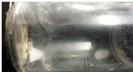
17 pav. Mikrodalelių sukėlimas cilindrinio indo sienelių savųjų formų mazginiuose pjūviuose esant įvairiems sužadinimo dažniams: a – 2,44 kHz; b – 14,2 kHz
