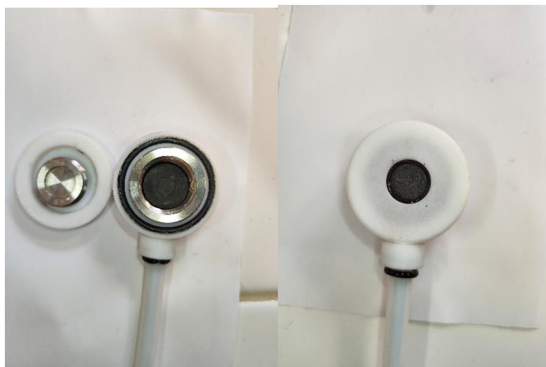
2 pav. Darbinio elektrodo laikiklis su JM tablete
