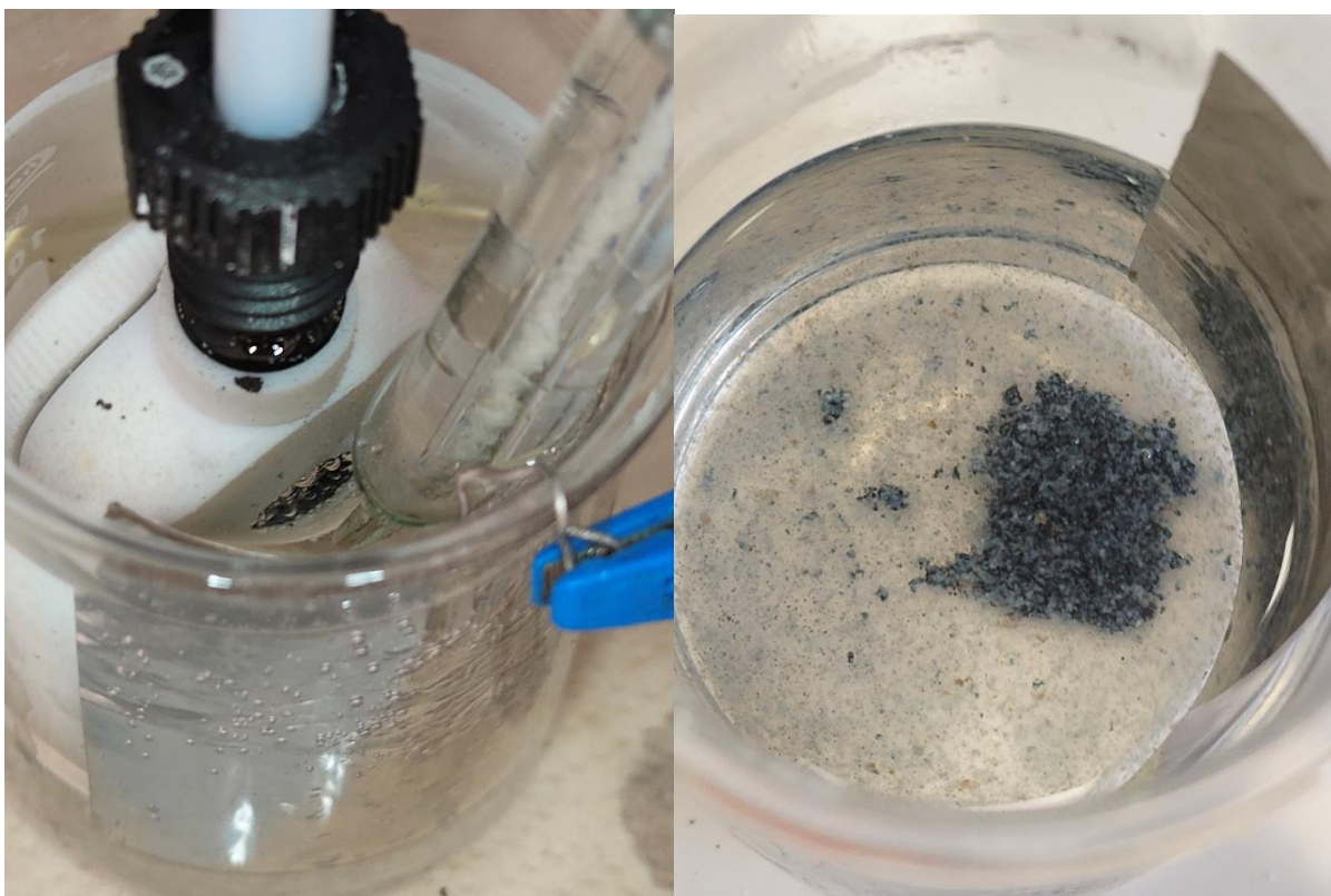
9 pav. Šalutinių reakcijų padariniai: deguonies evoliucija ties \sim 1,3 V pagal \text{AgCl}/\text{Cl}^- (sot. \text{KCl} ) ir tabletės matricos irimas.
