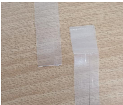
24 pav. Bandinio trūkimas per siūlę
