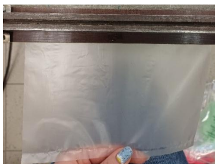
15 pav. Maišelio bandinys litavimo metu
