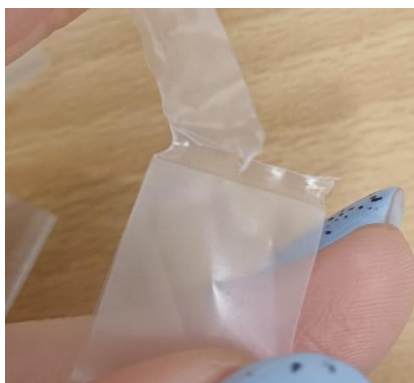
25 pav. Siūlės deformacija po bandymo
