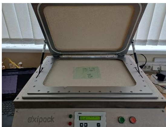
26 pav. Bandinys „Oxipack“ vakuuminėje kameroje prieš sandarumo testą
