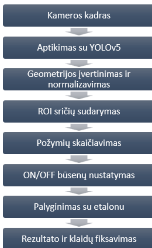
19 pav. Vaizdų apdorojimo algoritmo blokinė schema
