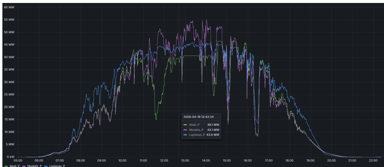
34 pav. Galutinės sistemos sukurto modelio realizacija veikiančioje elektrinėje palyginti su Laplaso transformacijos prognoze ir tikra aktyvia galia
