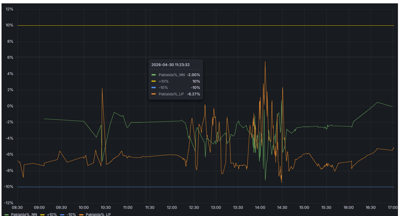
36 pav. Galutinės sistemos sukurtu naujesnio modelio realizacija veikiančioje elektrinėje palyginti su Laplaso transformacijos prognoze išreikšta procentine paklaida nuo leistinos generuoti galios
