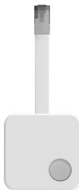
6 pav. P1 prievadas išmanaus elektros energijos skaitiklio duomenims nuskaityti
