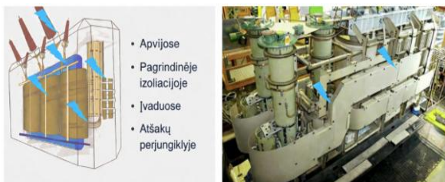
3 pav. Tipinės dalinių išlydžių susidarymo vietos autotransformatoriuose [19]
