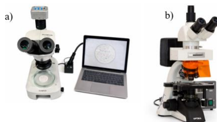
21 pav. a) Stereomikroskopas, „Olympus SZ61“ b) Fluorescencinis mikroskopas „OPTIKA B-353FL“
