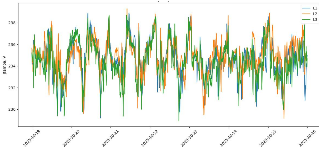
10 pav. Normalų veikimo režimą atitinkančio skaitiklio įtampos grafikas
