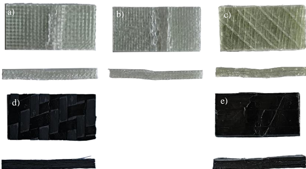
3.8 pav. Bandiniai po trumposios sijos bandymo: a) stiklas, stambus pynimas b) stiklas, smulkus pynimas c) stiklas, dvikryptis d) anglis, dvikryptis e) anglis, vienakryptis
