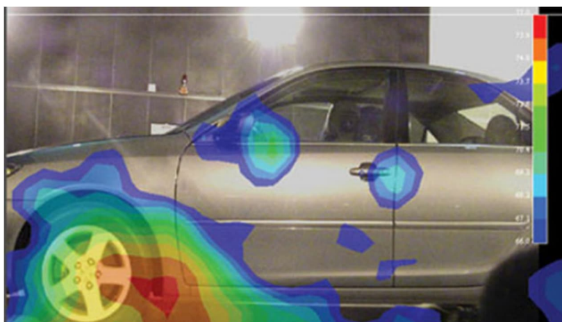
24 pav. Akustinis automobilio keliamo triukšmo tyrimas vėjo tunelyje [39]
