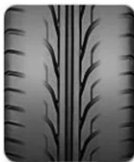
15 pav. Padangos dilimas esant slėgio trūkumui [27]
