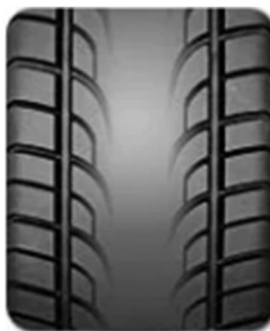
16 pav. Padangos dilimas esant slėgio pertekliui [27]
