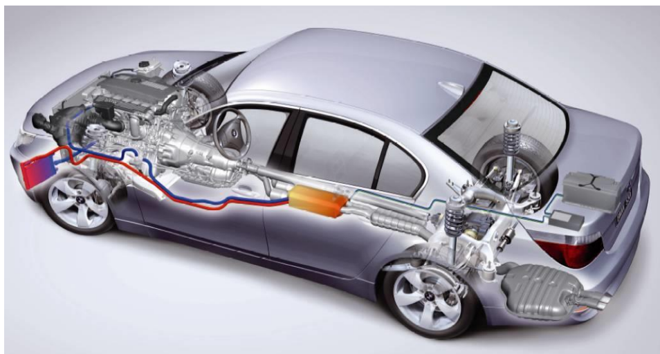
13 pav. „BMW“ automobilio pirmasis TEG prototipas [27]
