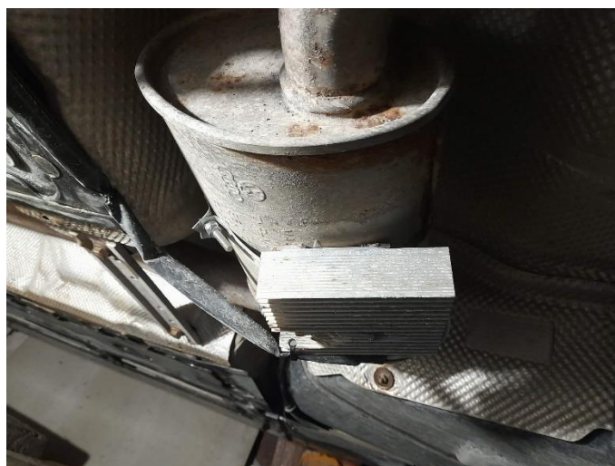
30 pav. Termoelektrinis generatorius ant automobilio išmetamųjų dujų vidurinio bakelio
