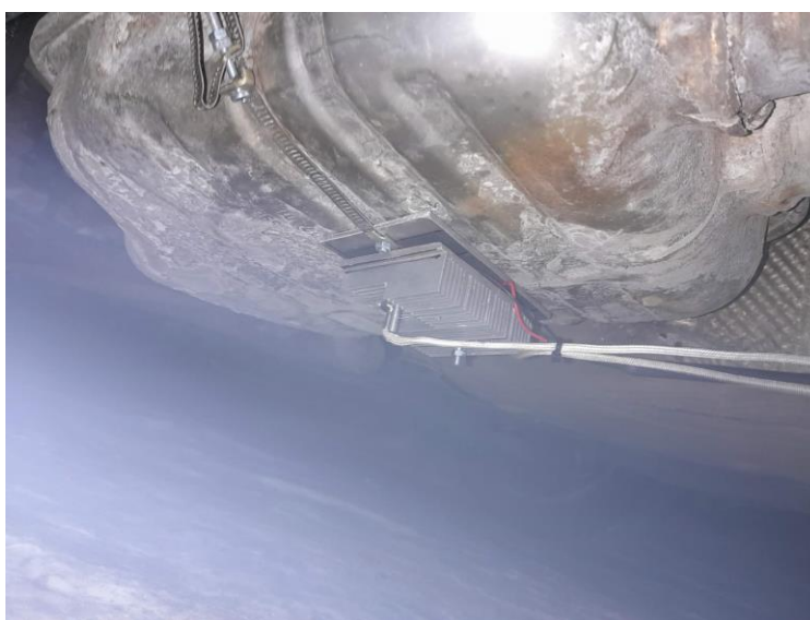
29 pav. Termoelektrinis generatorius ant automobilio išmetamųjų dujų galinio bakelio
