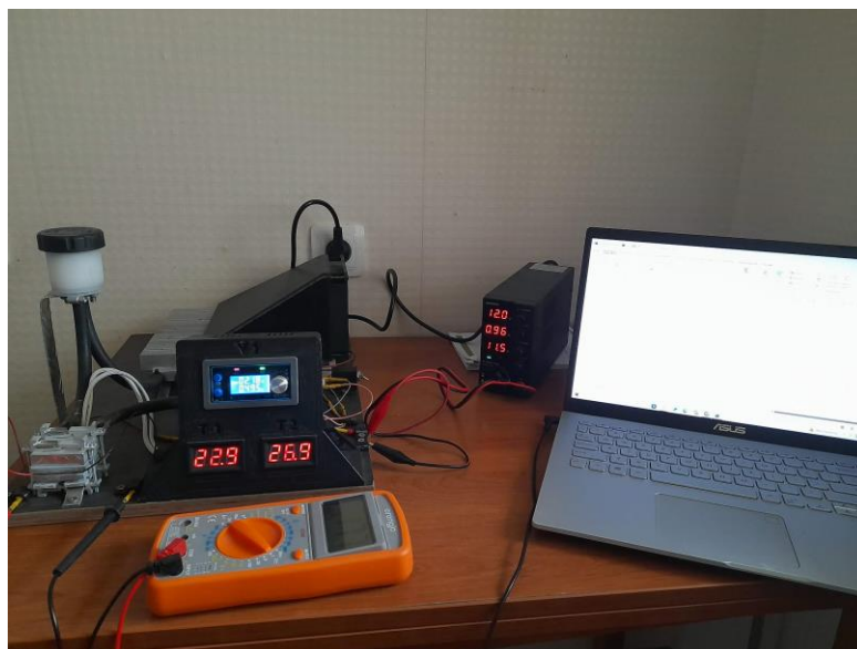
26 pav. Termoelektrinio generatoriaus tiriamasis stendas
